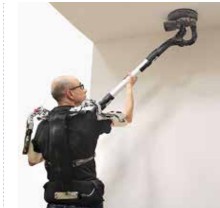
Ein Exoskelett unterstützt die Muskeltätigkeiten der Arme und verlängert somit die Ausdauer des Handwerkers erheblich. Quelle: Helmut-Schmidt-Universität
