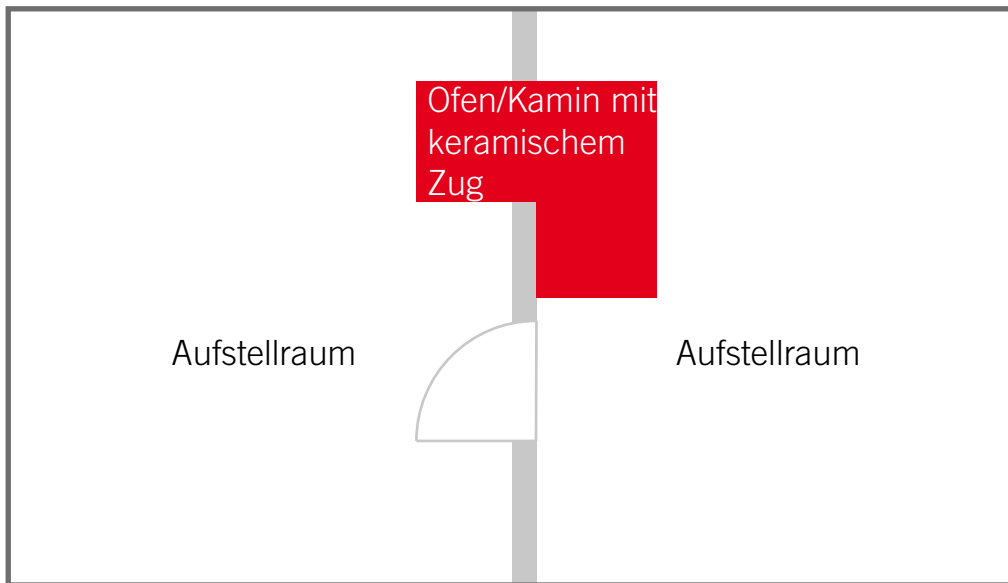
Abbildung 4: Einzelraumfeuerungsanlage mit keramischem Zug in zwei getrennten Aufstellräumen
