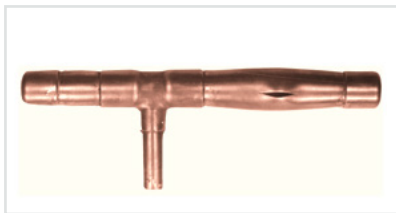
Bild 5.2 Weichgelötete Rohrkombination 22 x 1 mm nach einer Berstdruckprobe von 280 bar (1063)
