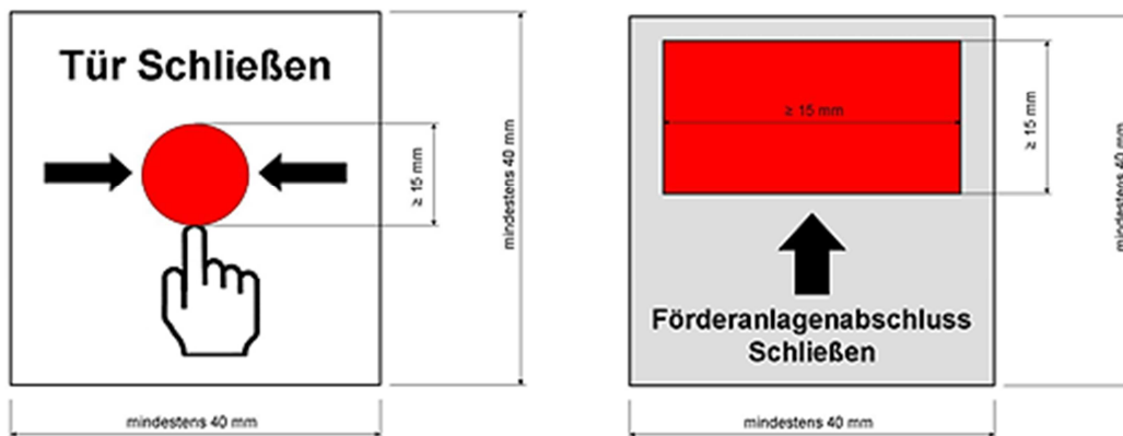
Bild 1: Beispiele für die Gestaltung von Handauslösetastern als Folientaster
