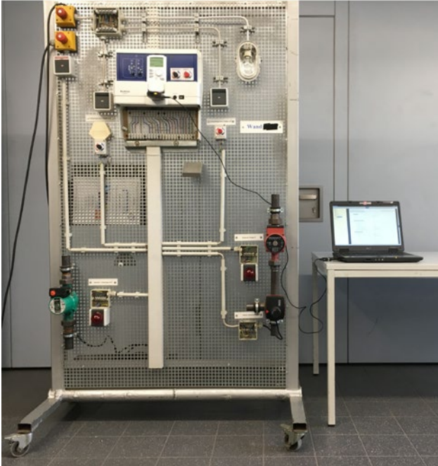
Abbildung 67: Ansicht 1: Einrichten und in Betrieb nehmen einer regelungstechnischen Anlage alle Einsatzgebiete (Quelle: BZD)
