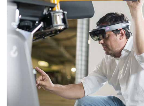
Detailkenntnisse für die Reparatur oder die Wartung lassen sich per Datenbrille vor Augen führen.
